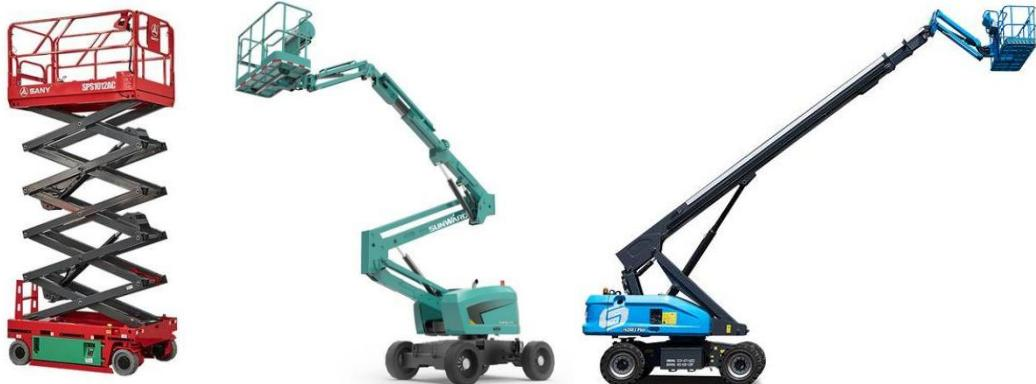
(1) 垂直桅柱式/剪叉式：工作高度一般 $\leq 20$ 米，平台稳定，作业面积大，适合立面平整的连续作业。
