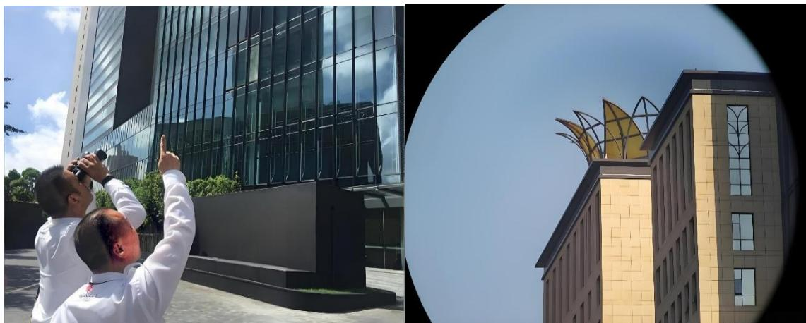
2、核心技术指标：望远镜放大倍率宜为 8-15 倍，物镜直径不小于 40mm，以保证足够的清晰度和视野。无人机应具备高分辨率摄像（4K 以上）和稳定悬停能力。
